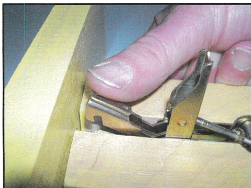
MISE EN PLACE DU CROCHET Bien mettre en place le crochet en manipulant légèrement le levier .
