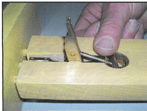
REGLAGE DU SERRAGE A L'AIDE DE LA MOLETTE Le levier doit être relevé au maxi . Régler selon l'effort voulu.
